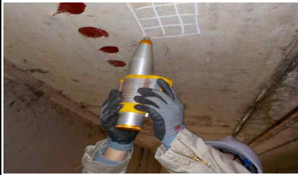
슈미트해머에 의한 반발경도 시험
